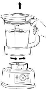
**7** Uklonite bokal sa baze motora okretanjem u suprotnom smeru od kazaljke na satu, a zatim ga podignite.
