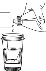
Napunite toploim vodom do vrha Power Paddle i dodajte 1 ili 2 male kapi sredstva za pranje sudova. Instalirajte sklop oštirca.
