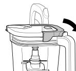
5 Postavite poklopac na bokal. Pritisnite dršku prema dole dok ne čujete klik. Kada je poklopac zaključan, pritisnite dugme za napajanje da uključite uređaj. Dostupni dugmići programa će se osvetliti i uređaj će biti spremjan za upotrebu.
